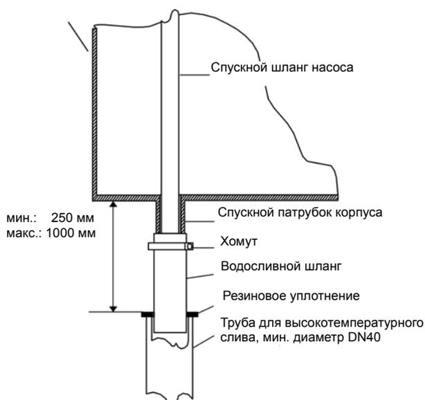
Отвод воды следует оборудовать следующим образом:
